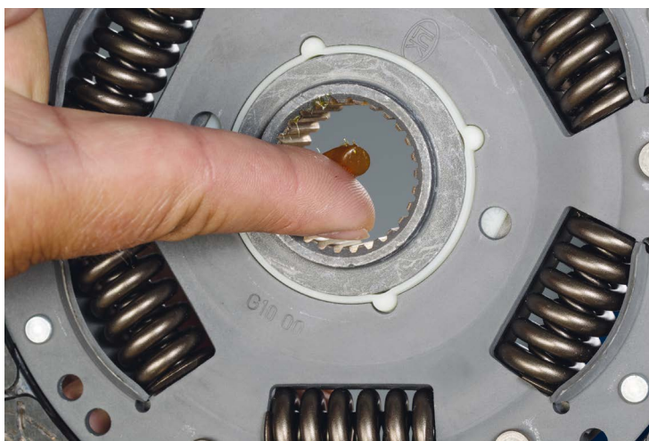
Фигура 1: Гресиране на шлиците на главината
