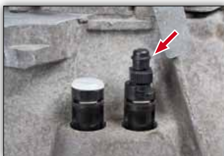
Снимка 8: Обезвъздушаващият нипел може да се задейства на ръка или с помощта на ключ (SW 13)
