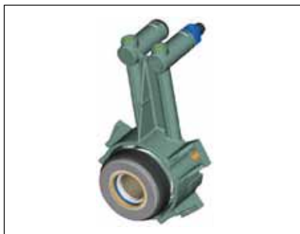
Снимка 1: Хидравличен изключващ лагер с отделен изход за обезвъздушаване
