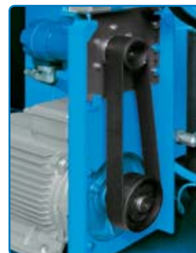
Trasmissione a cinghia Poly-V.
