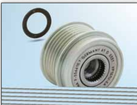
Снимка 3: При монтажа на механизъм за свободен ход на генератор на генератор Bosch (Ford Transit) трябва да се използва приложеният дистанционен елемент с дебелина от 1,4 мм!
