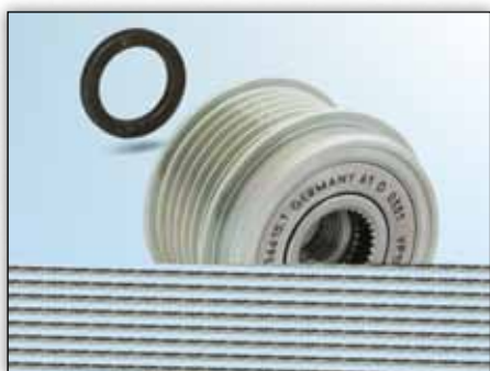
Снимка 2: При монтажа на механизъм за свободен ход на генератор на генератор Visteon (Ford Mondeo III) трябва да се използва приложеният дистанционен елемент с дебелина от 3 мм!
