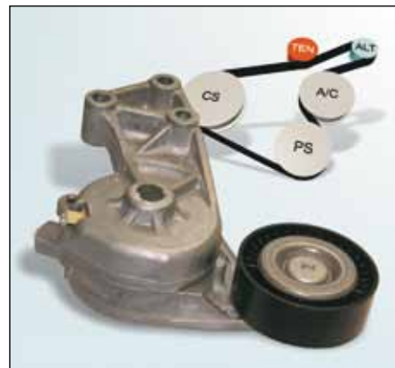
Снимка 2: Обтегачо рамо, което е монтирано на двигатели 1.9 TDI с път за ремък
