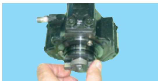
Блокирала ексцентрикова ос (не се върти на ръка)
