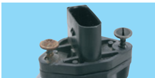
Повредени, развити или сменени винтове, подбит шлицц на винта
