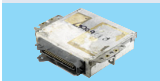
Компютърни блокове: подбита кутия, счупен щекер, пренатягане на винта и подгъване на краищата на капака. Липсващ или отворен капак. Следи от вода.
