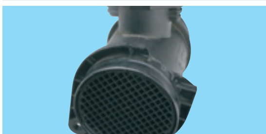
Повреден корпус или предпазна решетка на въздухомера
