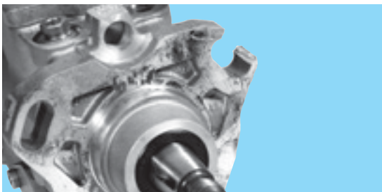
Подбит задвижващ вал или фланец, оцветяване на вала вследствие прегреване
