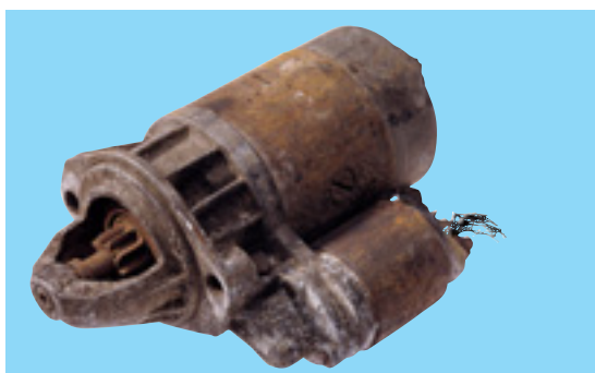
Силна корозия (Релефна, ронеща се, люспеста повърхост)
