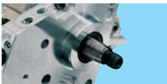
Подбит задвижващ вал или оцветяване на вала в следствие прегряване
