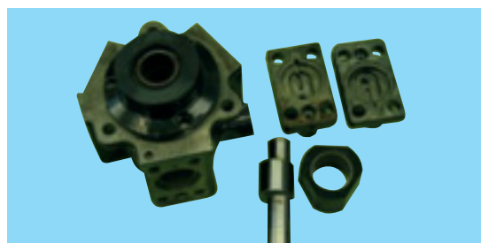
Помпата е непълна или е в разглобено състояние
