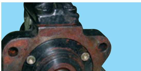
Силна корозия (Релефна, ронеща се, люспеста повърхост)
