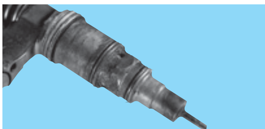
Силна корозия (Релефна, ронеща се, люспеста повърхост) - помпа дюза
