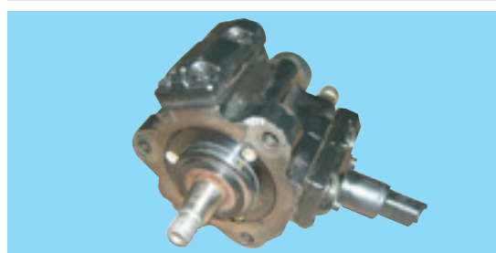
Счупен или пукнат корпус на помпата
