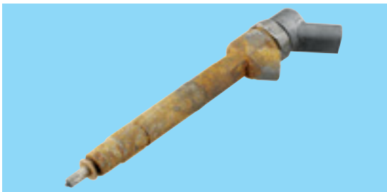
Силна корозия (Релефна, ронеща се, люспеста повърхост)
