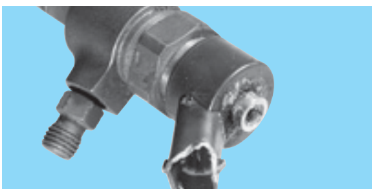
Отчупена част от електрическия конектор или стопен конектор
