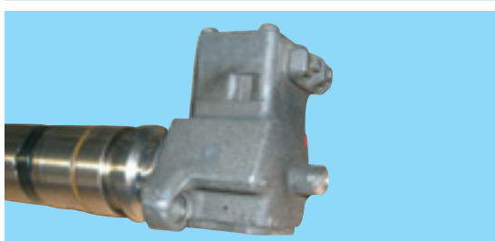
Повредена резба на конектора за високо налягане при помпа-тръба-дюза
