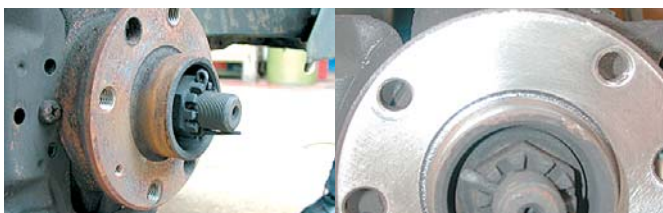
Главина при демонтиране на стария диск (горе) и при монтиране на нов диск (долу)
