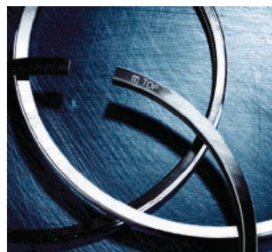
Маркирани с „TOP“ пръстени трябва да се монтират с маркировката нагоре (в посока към дъното на буталото).
