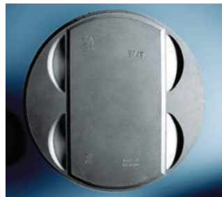
На дъното на буталото са посочени фирмената или търговската марка, максималният диаметър на буталото, монтажната хлабина и монтажната посока съгласно изискванията на съответния производител на двигатели.
