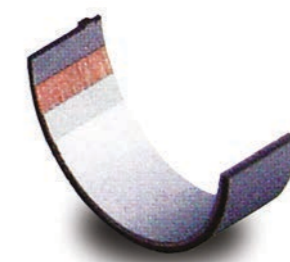
Триметални лагери Състоящи се от стоманена опорна втулка, лагерен слой, бариерен слой и плъзгащ слой – за употреба при двигатели с високо натоварване. Ефективността им се подобрява посредством йонно разпръскване – за повишена твърдост, устойчивост на натоварвания и износване. Лагерите с йонно разпръскан слой са предназначени за двигатели със свръхпълнене и охлаждане на подавания въздух, но намират и все по-често приложение при дизелови двигатели за леки автомобили.
