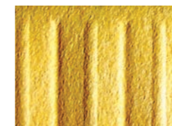
Филтърна хартия след нагъване на отвесни ивици.
