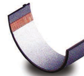
Биметални лагери За бензинови двигатели с ниско до средно натоварване и дизелови двигатели с всмукване на гориво при леки автомобили; състоящи се от стоманена опорна втулка, междинен слой и слой лагерен метал (най-често алуминиеви сплави).
