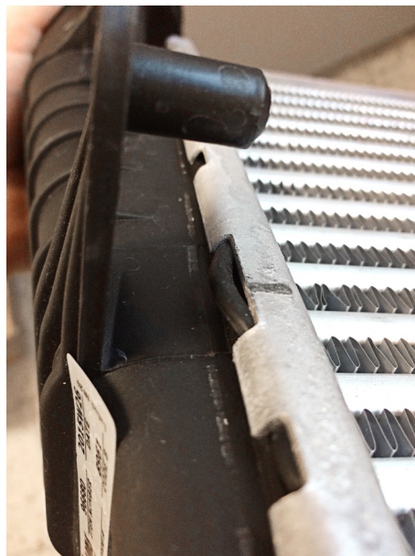
Ненормално високо налягане в система може да предизвика деформация на пластмасовото казанче (капак).
