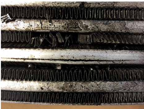
Ламелите са повредени поради ненормално налягане. Тази повреда често се приписва на технологични грешки в тръбите. Все пак, прекомерното количество масло в интеркулера, показва неизправност на налягането в системата.
